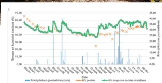
Comparaison de trois mesures différentes : pesée, mesure résistive et précipitations
