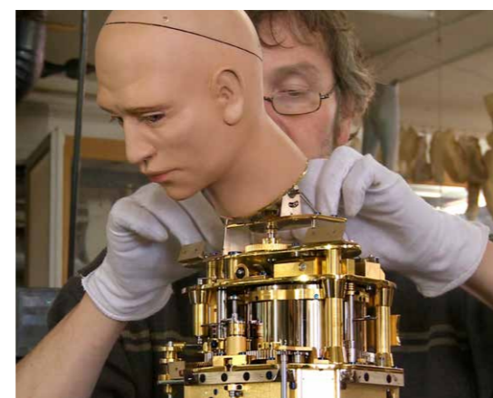
Un automatier effectue le réglage du mécanisme sur un androïde, automate reproduisant des gestes humains comme écrire et dessiner. Il s'anime grâce à un système exclusivement mécanique composé notamment de cames, engrenages, leviers et ressorts.
