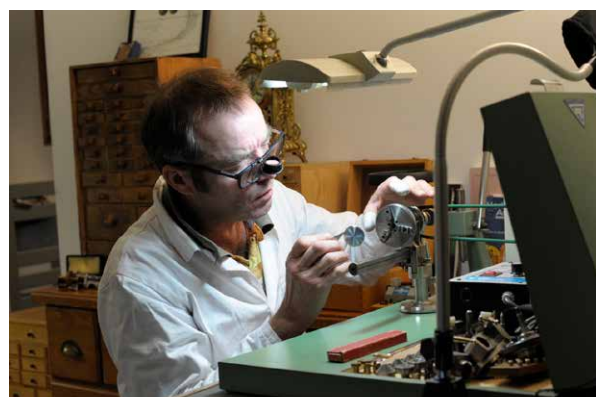
Un maître horloger fabriquant une pièce sur son tour horloger pour un objet à restaurer
